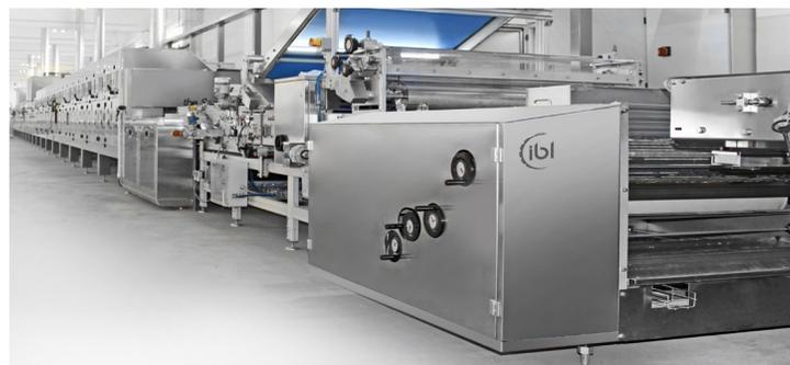
*Il forno a gas diretto è adatto per prodotti a pasta morbida fino a cotture di crackers. Abbinato al sistema ciclotermico o a quello a convezione può essere inoltre utilizzato per formare soluzioni ibride per altri tipi di prodotto.*
